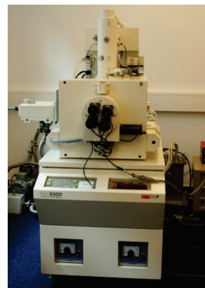
Abbildung 1.15: Aufbauschema der Ionensäule und Foto der FIB-Anlage Seiko SMI-8300.
