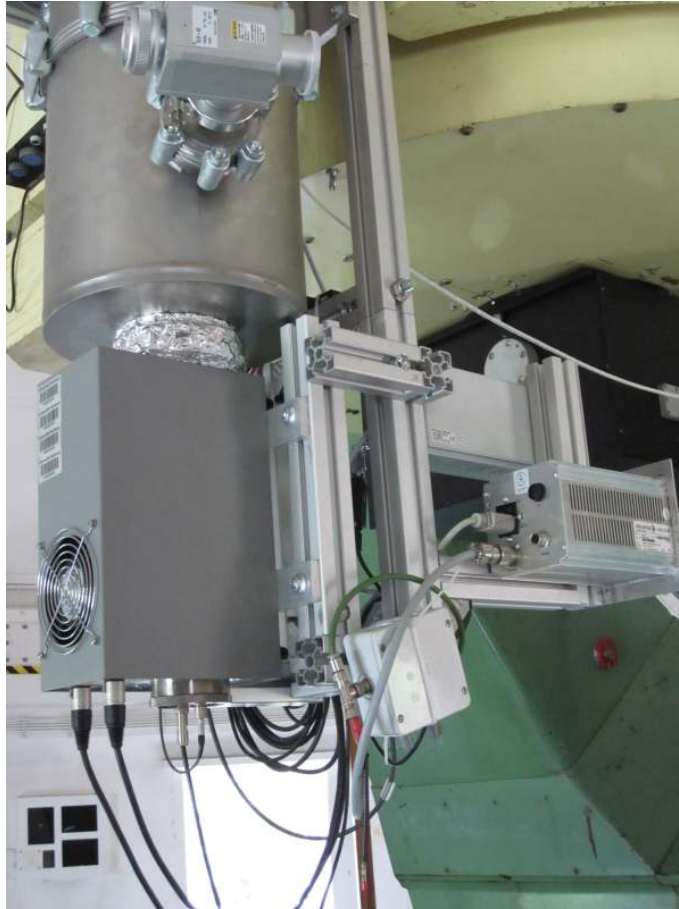
ABBILDUNG 4.3: Mit der variablen Detektorhalterung von TSHIPS ist es im Betrieb einfach, problemlos, sicher und schnell möglich, zwischen verschiedenen CCD- und Photomultipliertypen zu wechseln.
