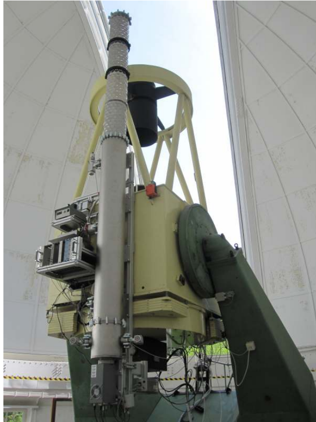
ABBILDUNG 4.1: Das Oskar-Lühning-Teleskop an der Hamburger Sternwarte in Bergedorf, an dessen Vorderseite das Telescope for the Solar Hidden Photon Search angebracht ist. TSHIPS nutzt das OLT als Teleskopmontierung für eine präzise Sonnenverfolgung in Langzeitmessungen. Beide Instrumente blicken in die exakt gleiche Richtung. Es kann der volle Azimuthbereich angefahren und Teleskophöhen zwischen 10^\circ und 90^\circ eingestellt werden.
