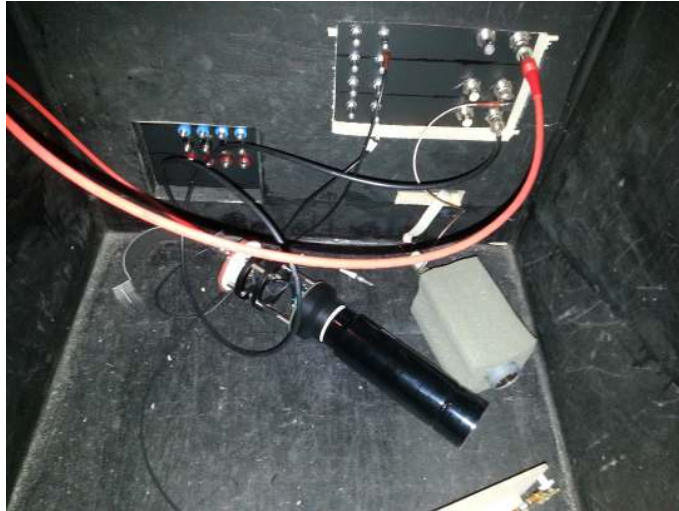
ABBILDUNG 5.20: Seitenwand u.a. mit mehreren BNC-, Lemo- und SHV-Durchlässen. Vorne links befindet sich die LED und im Abstand von jeweils 14 cm die beiden zu vergleichenden Photomultiplier ET 9893/350B und XP2960.
