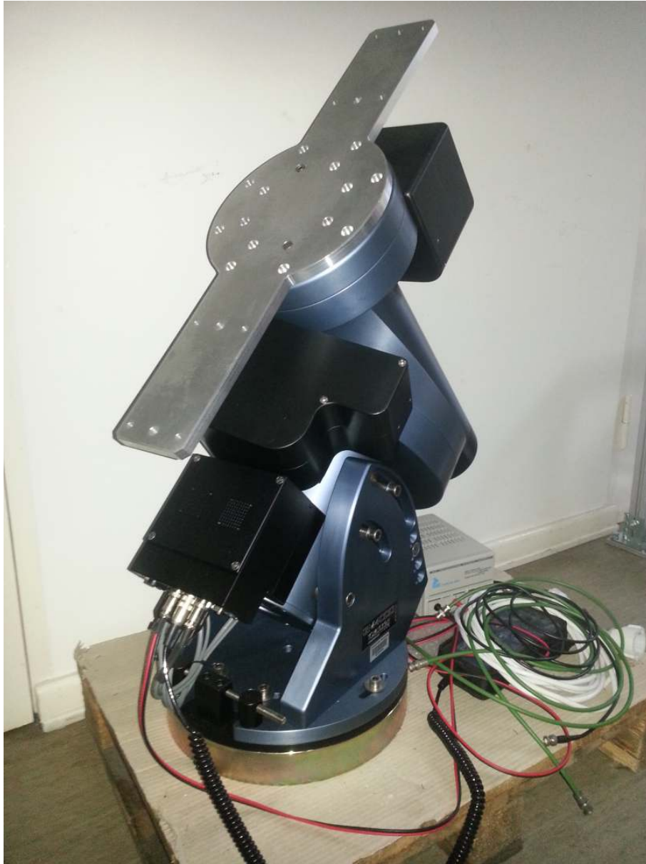
ABBILDUNG 8.1: Die GM4000-Montierung von 10Micron bietet mit einer Traglast von 150 kg die Möglichkeit, die Wölbstrukturröhre, einen Detektortopf und das Gewicht aller weiteren Komponenten zu tragen. Zudem bietet die Montierung einen vollen Operationskreis von 360^\circ im Azimuthbereich und steuert Höhen von 90^\circ bis 10^\circ bei einer Trackinggenauigkeit von \pm 3 Bogensekunden an [72].
