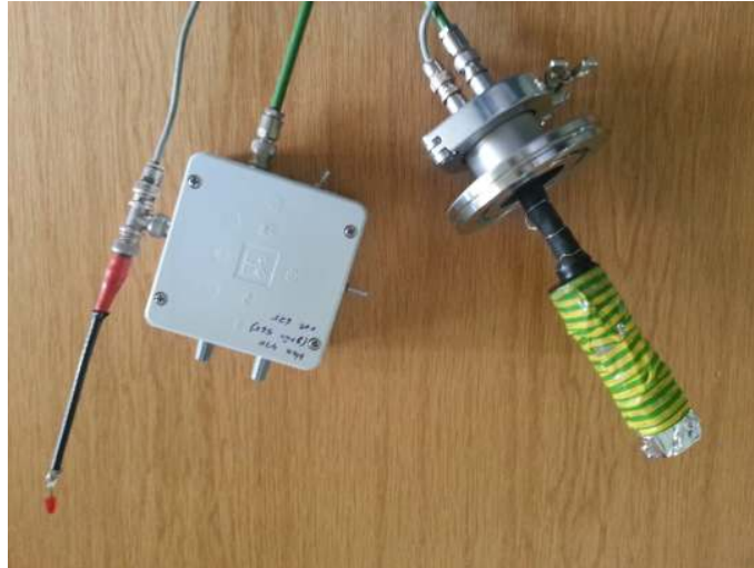
ABBILDUNG 4.12: Darstellung der größtenteils abgedeckten LEDs zum Testen des gesamten optischen Systems und des PMTs von TSHIPS. Über eine stabile, starre Kabelverbindung sind diese fest an einer speziellen Vakuumdurchführung und etwa auf Höhe der optischen Achse des Aufbaus angebracht. Mit der weißgrauen Steuerbox können von außen Helligkeit und Leuchtfrequenz der LEDs variiert werden.
