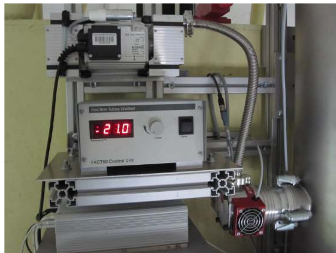
ABBILDUNG 4.11: Steuergerät für das FACT50-Kühlgehäuse. Durch Selbstregulierung hält das FACT50 die Temperatur des ET 9893/350B konstant auf -21,0^{\circ} C.
