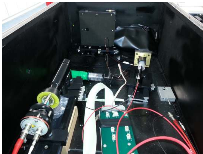
ABBILDUNG 5.9: Blick in das Innere des ZEUS-Teststands: Zu sehen ist der ET 9893/350B in dem Aufbau, wie er für die in diesem Unterkapitel beschriebenen Messungen genutzt wurde. In der linken Hälfte der Rückwand befinden sich die LEDs auf gleicher Höhe mit dem PMT.
