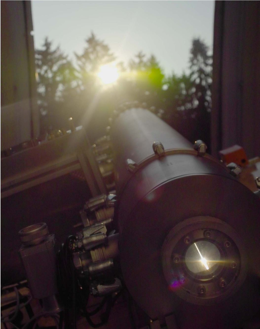
ABBILDUNG 5.3: In den Trackingtests von TSHIPS stellte sich heraus, dass das Helioskop selbst nach einem ganzen Tag des Nachführens an der Sonne diese nach wie vor präzise im Blickfeld hat wie in diesem Beispiel zur Abendzeit.
