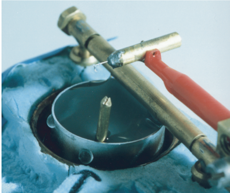
Abbildung 3.2: Transfermaschine und Probenhalter zur Montage der Kristalle
