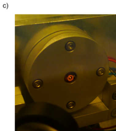
Abbildung 7.18: a) Experimenteller Aufbau des Phasenschrittinterferometers; b) Abbildung des Pumpflecks durch einen 1064 nm Bandpassfilter; c) Orangefarbene Fluoreszenz im gepumpten Kristall, fotografiert durch Laserschutzbrille.
