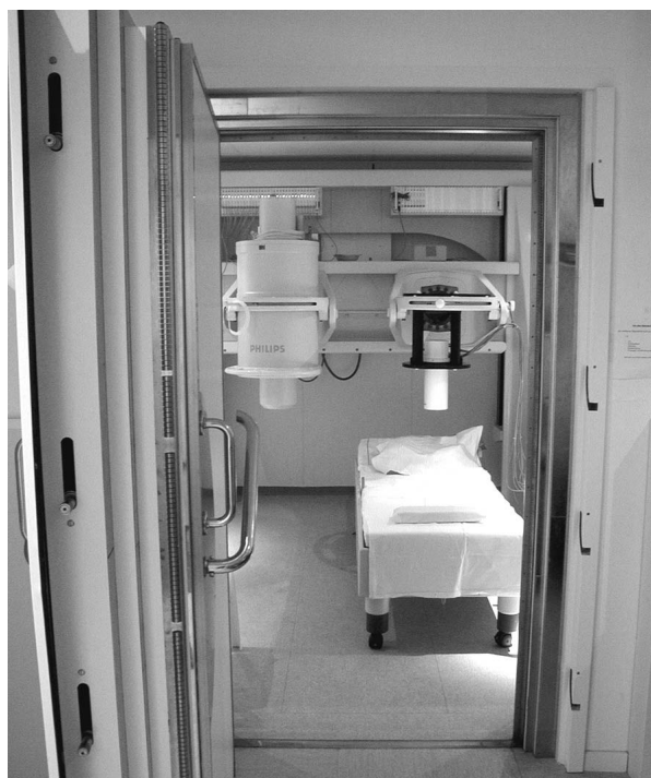
ABBILDUNG 6.2: Blick in die Abschirmkammer des Instituts für Physiologie im UKE mit eingebautem und messbereitem HTS-System in der schwarzen Kunststoffhalterung.
