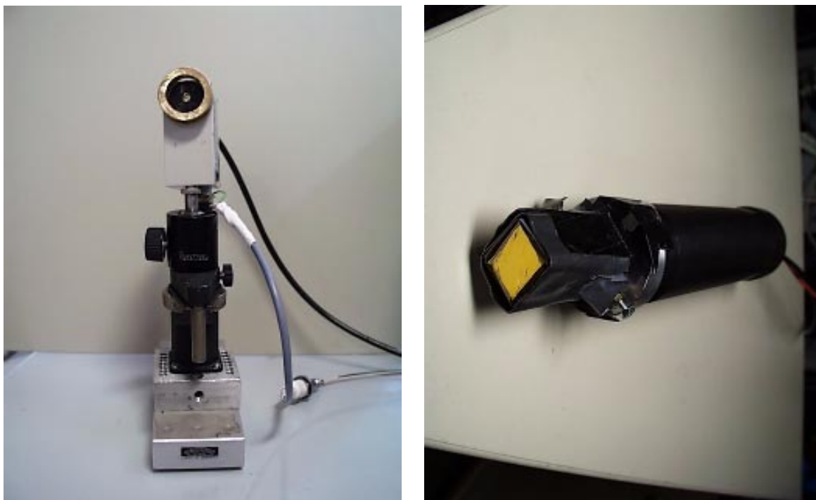
Abbildung 3.5: Links: Das APD-Modul zum Nachweis der Laserstrahlung. Rechts: Der Szintillationszähler, Ansicht auf die probenzugewandte Seite.
