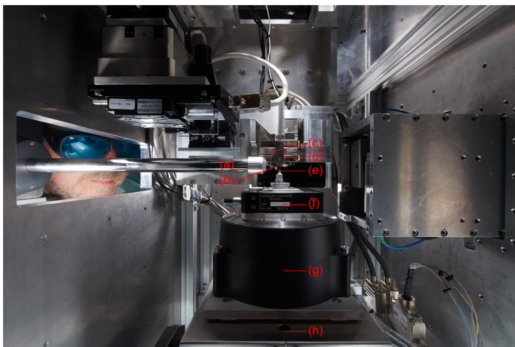
Abbildung 2.5: Blick ins Scannergehäuse mit (a) Fluoreszenzdetektor, (b) Linsenhalter mit NFLs, (c) Slip-Stick Piezomotoren zur Linsenjustierung, (d) Lochblende, (e) Probe, (f) Piezoscanner, (g) Rotationsachse und (h) Linearhub (DESY, 2010).
