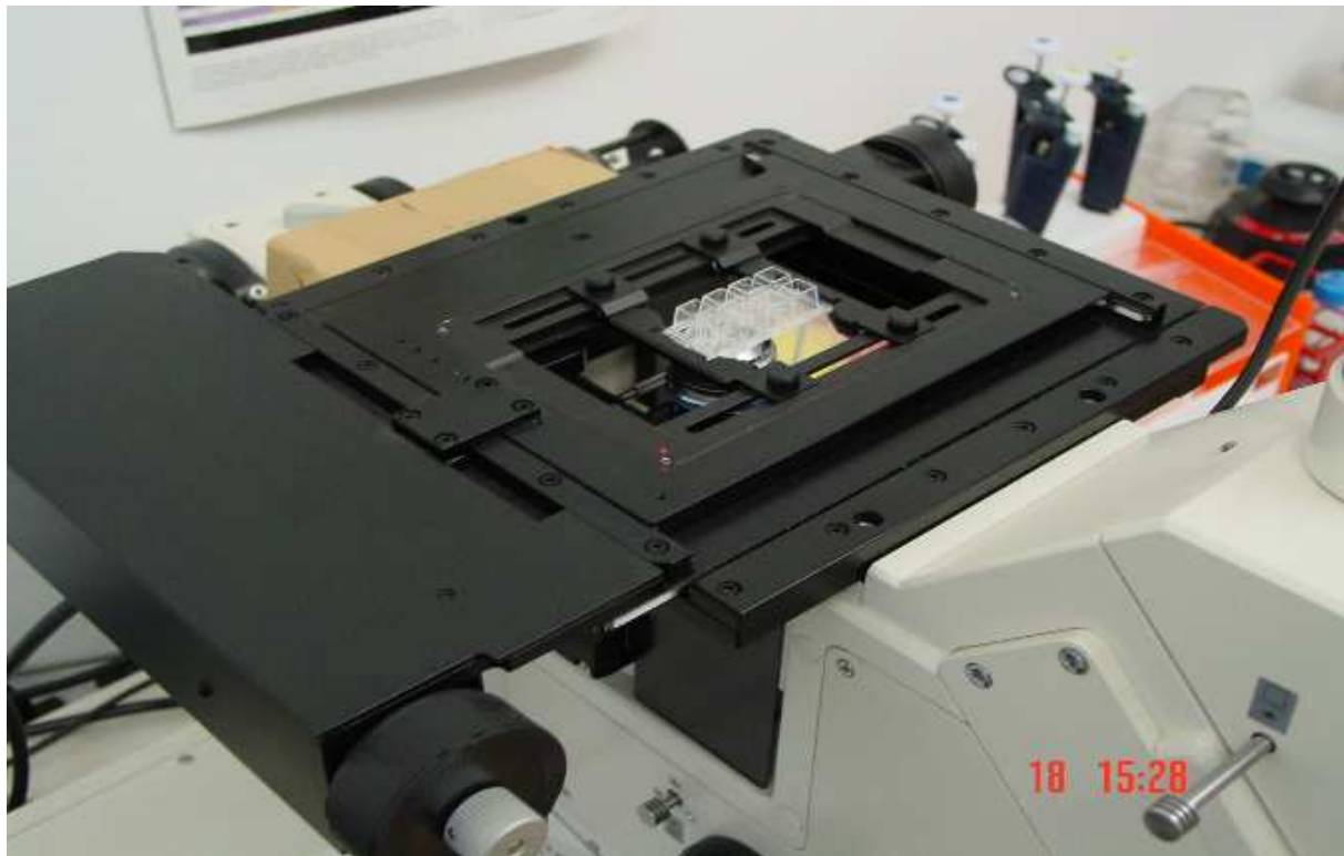
Abbildung 3.14: Der Probentisch des Meßaufbaus. Mit den seitlich angebrachten Schrittmotoren, ist er \mu\text{m} -genau zu positionieren. In der Mitte sind die quadratischen Probenkammern zu sehen.
