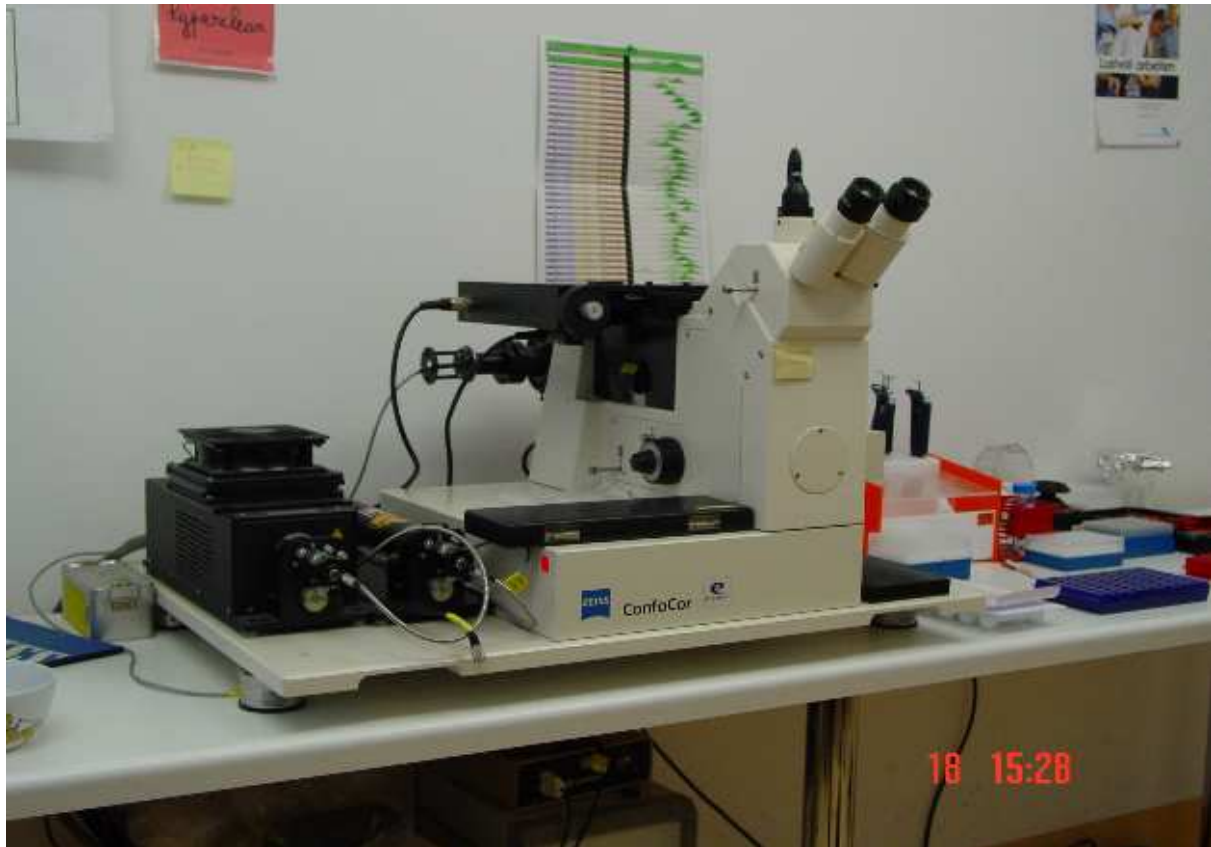
Abbildung 2.2: Die Darstellung zeigt den realen Aufbau der FCS-Messanordnung mit den Komponenten Laser und Mikroskopeinheit.
