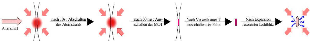
**Abb. 27 :** Ablauf einer Temperaturmessung (TOF-Messung). Nach dem Laden und Abschalten der MOT sind die Atome eine bestimmte Zeit in der Dipolfalle gefangen. Dann wird das Fallenlicht schlagartig ausgeschaltet und die Atome können frei expandieren. Nach einer bestimmten Expansionszeit wird resonantes Licht eingestrahlt, und die Verbreiterung der Gaußverteilung der Atome gemessen.
