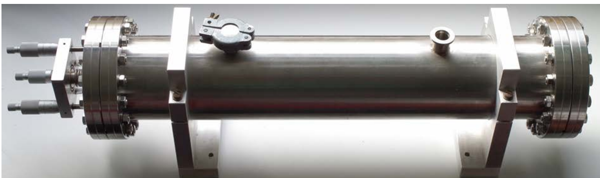
Abbildung 90: Absorptionszelle mit justierbarem Spiegelhalter, Vakuum-Anschlüssen und integriertem Lautsprecher.
