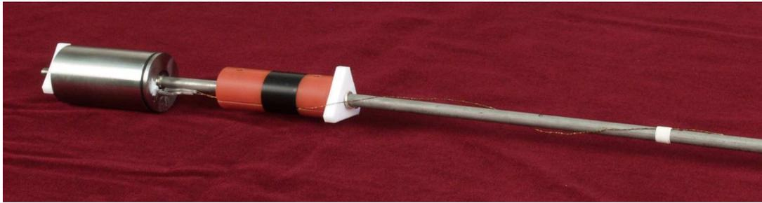
Abbildung 3.16: Probenhalter zur Proteinkristallzüchtung nach der *batch*-Methode im *VTI* des 16 T-Magneten. Die sich im Bild links befindende Probenkammer läßt sich gasdicht verschließen.
