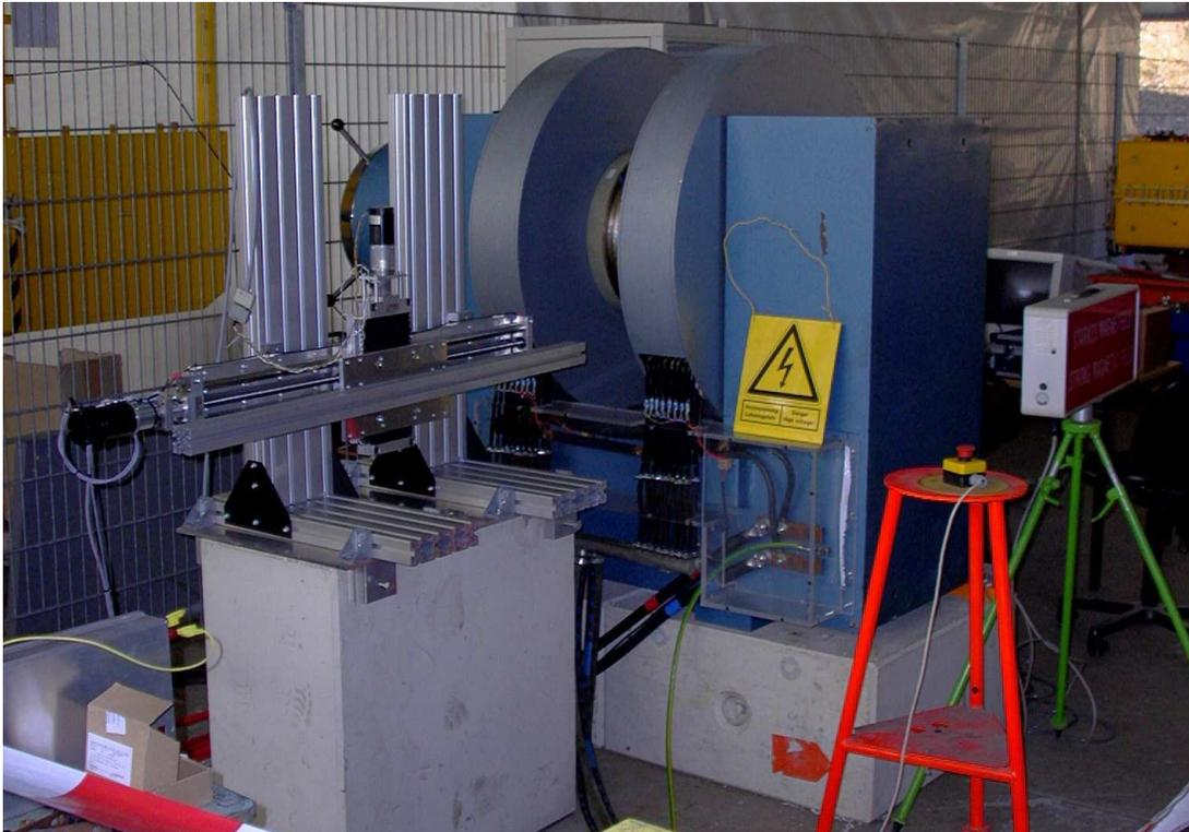
Abbildung 3.13: Messaufbau aus x, z-Translationen zum automatischen Ausmessen des Magnetfeldes des PROLET.
