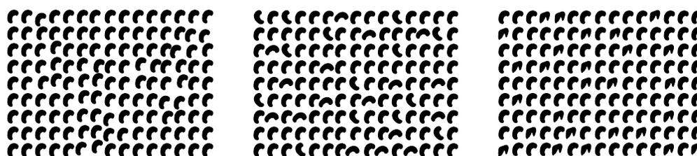
Abbildung 2.7: Verschiedene Formen der Fehlordnung in Proteinkristallen (v.l.n.r.): Positionsfehlordnung, Orientierungsfehlordnung und Konformationsfehlordnung (in Anlehnung an [30]).
