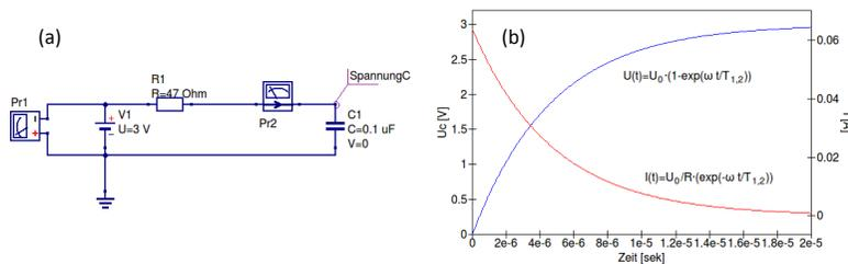
Abb. 8: RC-Tiefpass : (a) Schaltplan eines RC-Tiefpasses. (b) Gemessene Spannung  $U_c$  und Strom  $I$  über der Zeit. Es wurden die gleichen Bauteile wie im Versuch verwendet ( $R=47$  Ohm und  $C=0,1 \mu\text{F}$ )
