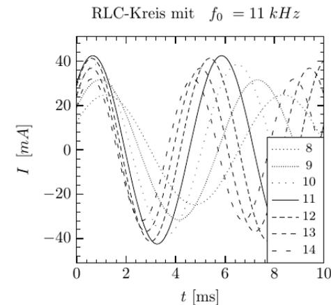
Abb. 5: Stromverläufe nach Gl. (8) bei unterschiedlichen Frequenzen. Grundlage hierfür ist die Kapazität von  $0,1 \mu F$  und Induktivität von  $L = 2 mH$  aus dem Versuch. Der Strom besitzt bei ca. 11 kHz also im Resonanzfall sein Maximum.
