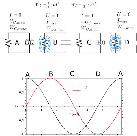
Abb. 2: Zusammenhang zwischen Strom und Spannung im idealen Schwingkreis. Die Spannung eilt dem Strom um  $\pi/2$  voraus.
