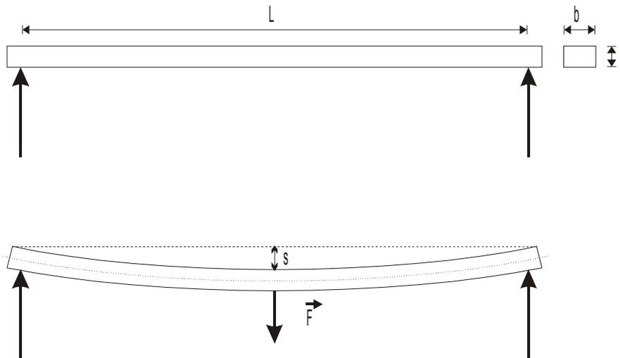
Abb. 1: Durchbiegung eines an den Enden aufliegenden Stabes
