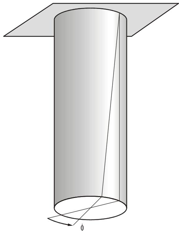
Abb. 2: Torsion eines einseitig befestigten Stabes
